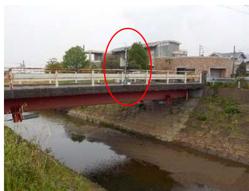
危機管理型水位計の設置事例（西古瀬川）
