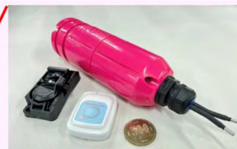
実証実験に用いている3種類の浸水センサ
