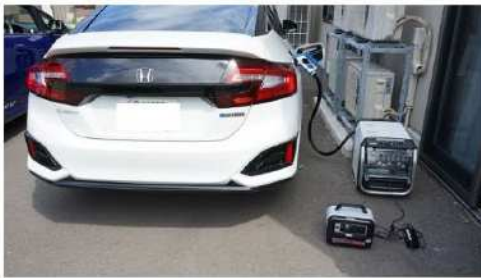
FCVからの給電：老人ホームでエアコンや小型蓄電池の充電に使用 出典：本田技研工業株式会社
