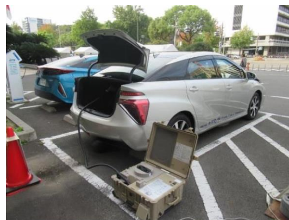
外部給電器を用いた給電デモ
