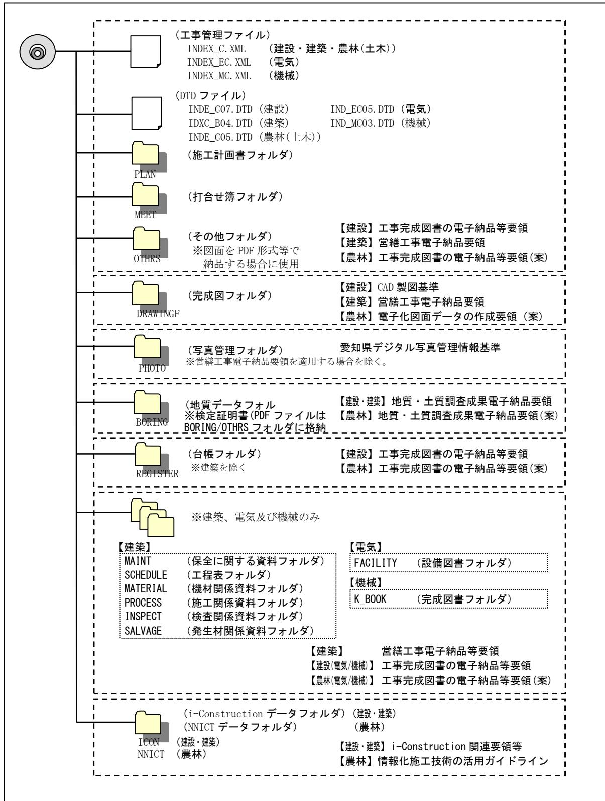
図-3 工事完成図書のフォルダ構成
