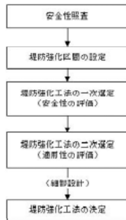
図1 堤防強化工法の選定の手順
