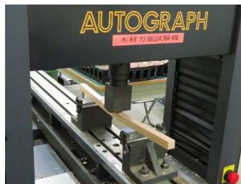
材質調査（曲げ強さ等の測定）
