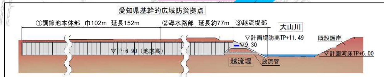
◆地下調節池断面模式図(3K400)
