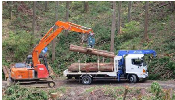
グラップルによる積み込み作業
