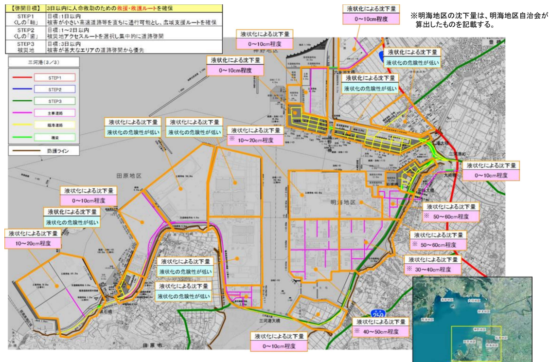
図- 1.7.7 地震ケース 2 (過去地震最大) における神野 2・明海・船渡・田原地区の 臨港道路等の被害想定結果
