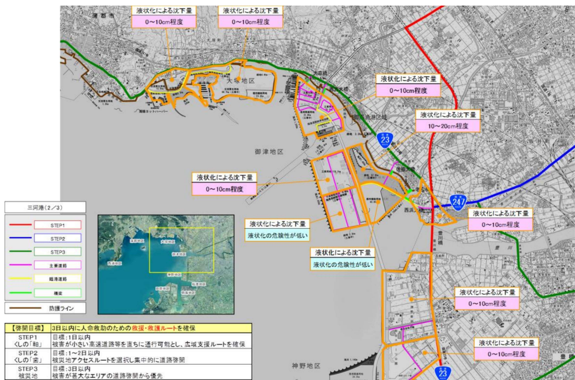
図- 1.7.6 地震ケース 2 (過去地震最大) における大塚・御津・神野 1 地区の 臨港道路等の被害想定結果
