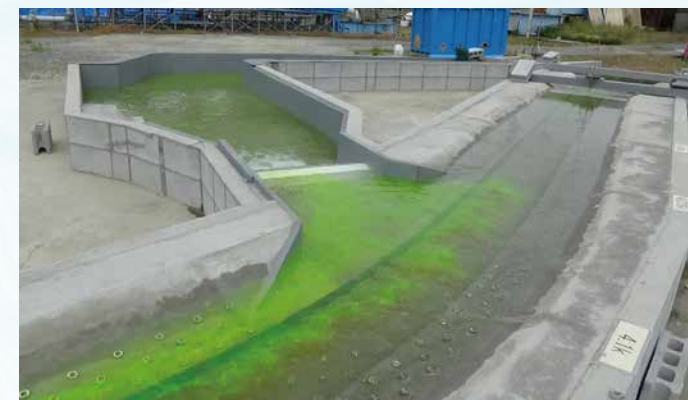
分水施設越流堤諸元検討実験の様子
