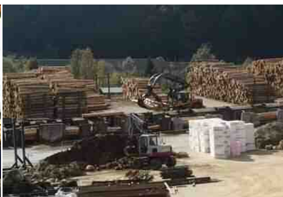
製材工場の土場での仕分け作業 ログローダーと選別ライン
