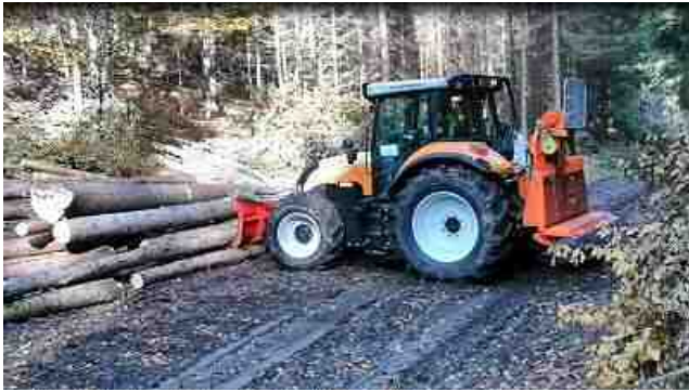
排土板を使ったはい積み
