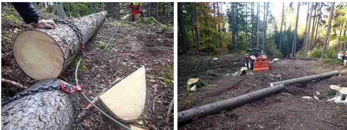
トラクターウインチ集材の様子（プロセッサなしのため8m造材×3本を集材）
