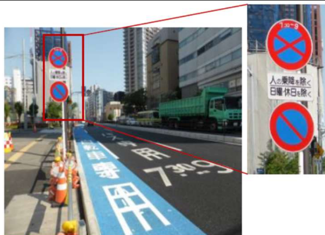
措置②：自転車専用通行帯の 駐車禁止の規制事例 【出典：国土交通省、警察庁】
