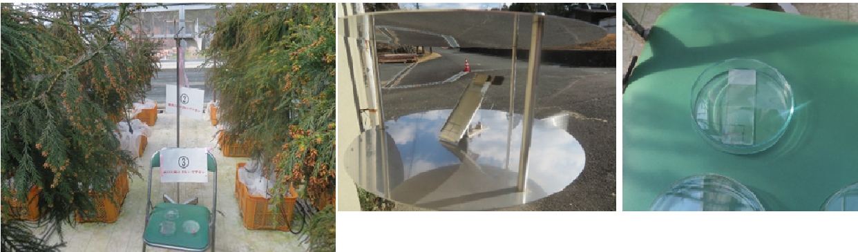
図－5 スライドガラスの設置状況 aは遠景（②はISロータリー型花粉捕集器）。bはISロータリー型花粉捕集器での近景。 cはパイプ椅子での近景
