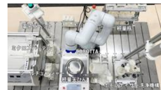
産総研中部センターの 粉体自動実験設備
