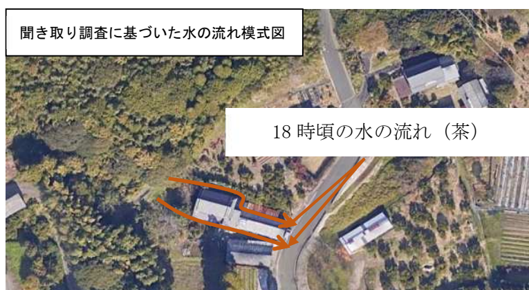
図-13 土砂崩れ発生日の水の流れ（国土地理院 Web ページに加筆）
