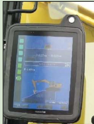
ICT建設機械による法面整形（日光川）
