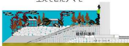
緩傾斜護岸化による藻場造成
