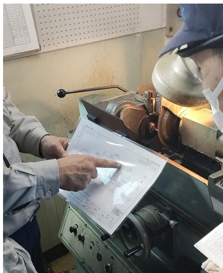
図5. ドリルテーパー角の 図面指示確認
