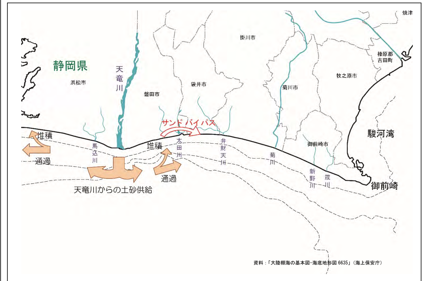
図 1.5.1 遠州灘沿岸の土砂管理による砂浜保全の概念図
