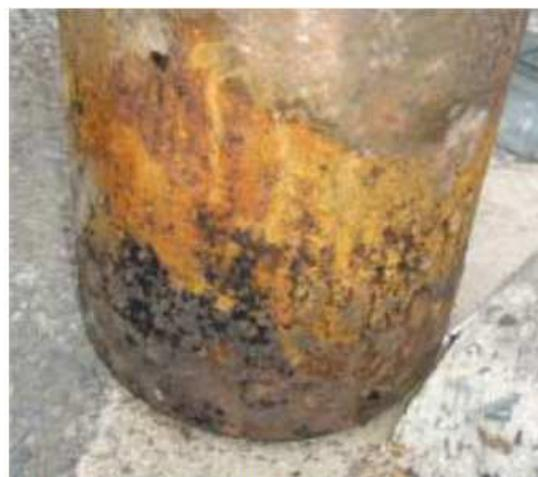
破裂しなかった容器の腐食状況
