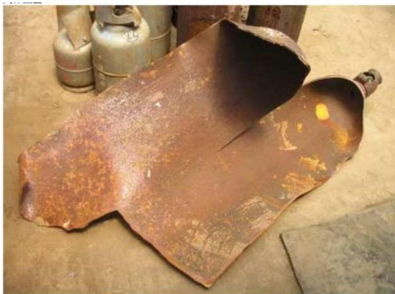
破裂容器の状況(最小肉厚 2.4mm)
