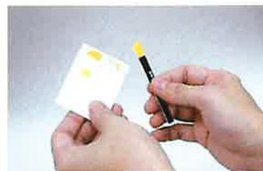
図付 4 変色試験紙の取り扱い
