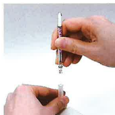
図付 1 検知管の取り扱い
