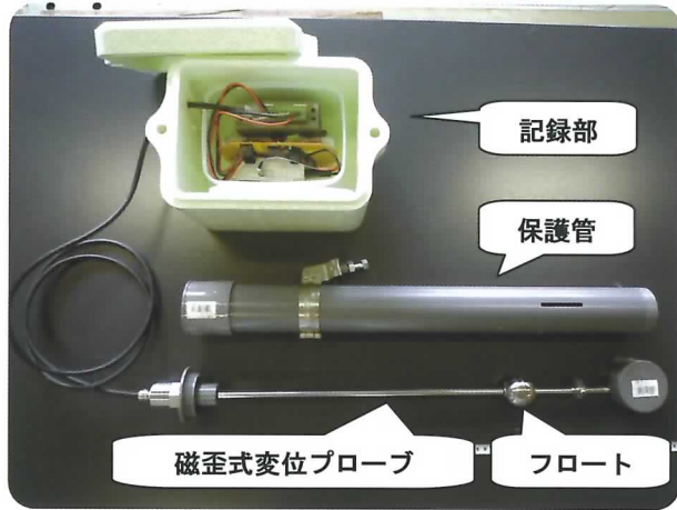
水田湛水深測定水位計の構造
