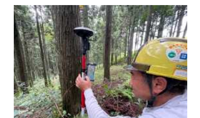
<測量等> GNSS 測量
