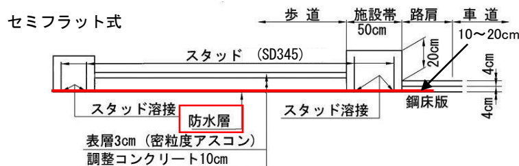
図 5.3.2 鋼床版の歩道部の舗装
