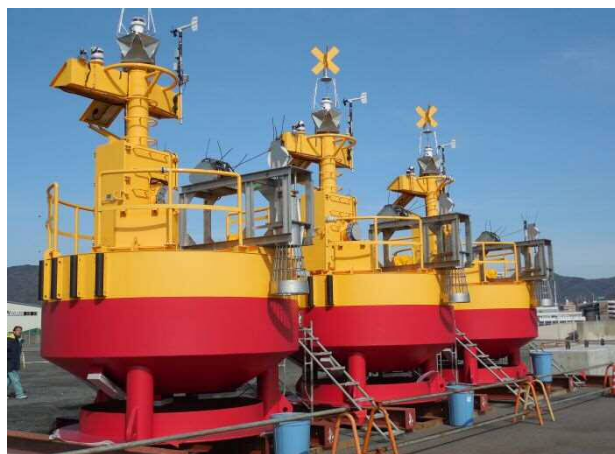
図IV-3-1 設置を待つ3機の新自動観測ブイ
