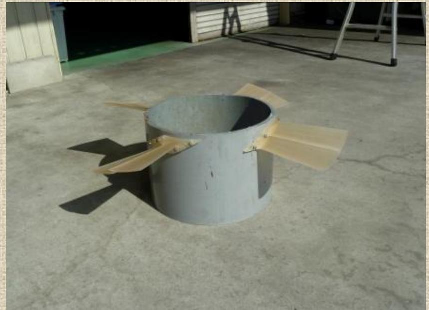
3D-プリンタで制作した螺旋羽根の試作品 (2013/10)
