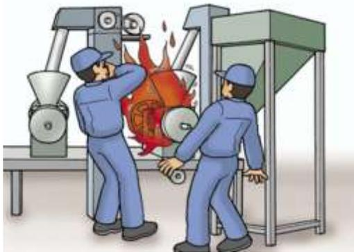
アルミニウムとマグネシウムの合金を粉砕加工する作業中に粉じん爆発が発生し、作業員2名が死亡した。
