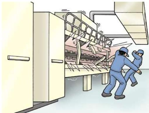
オフセット印刷機で印刷作業中、都市ガスを燃料とする乾燥設備が爆発し、作業員が負傷した。
