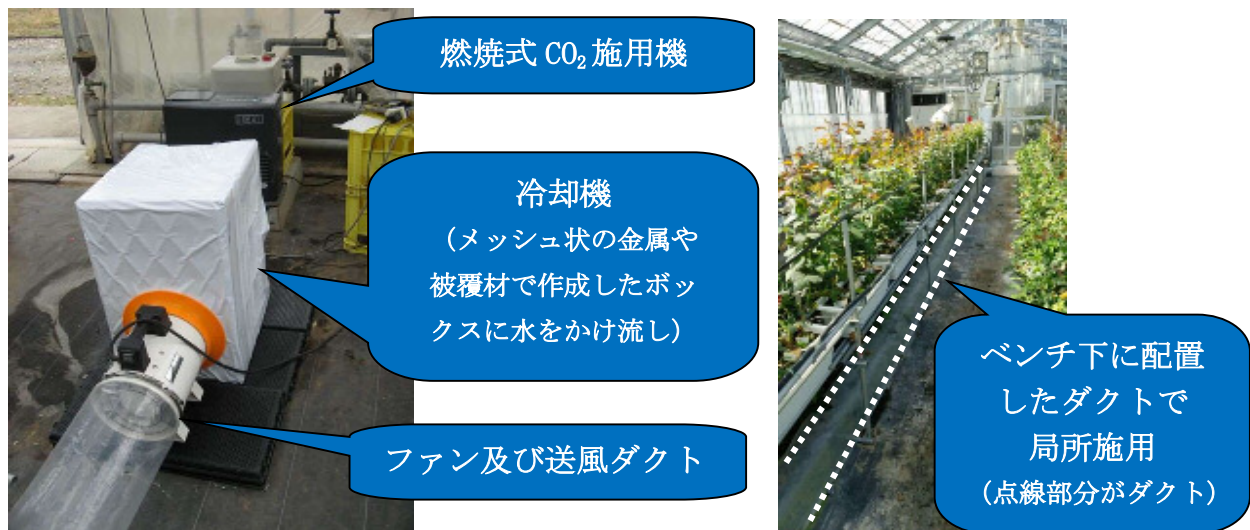
図 1 灯油燃焼式 CO 2 施用機による局所施用方法
