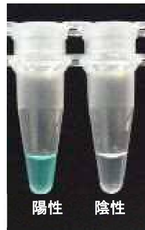
LAMP 法による陽性判定の一例
