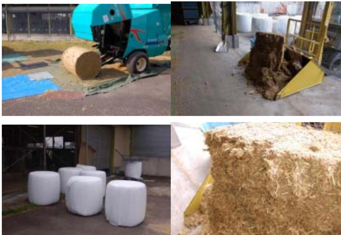
写真2 裁断型ロールペーラーによる成形作業(左上)、給餌(右上)
