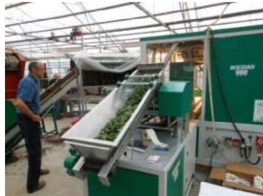
写真3 自動で挿木を行う機械
