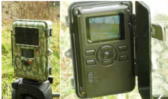
写真1 トレイルカメラ（左：外観、右：内蔵モニター）
