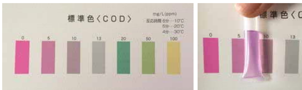
写真1 パックテストを用いた測定
