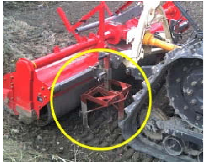
写真2 わだち解消のため自作した小型スキ
