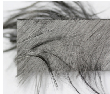
(1)エポキシマトリックスC-FRPの表面
