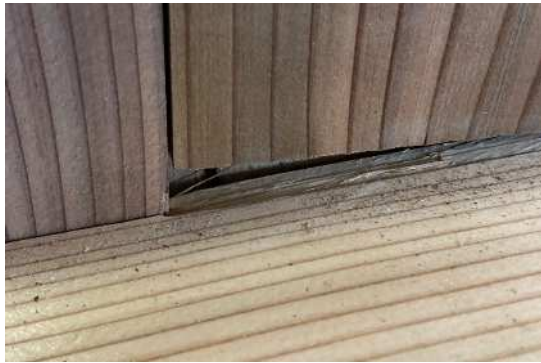
図-15 板のめり込み（試験体 3）
