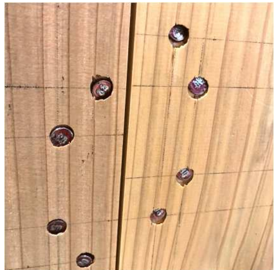
図-18 30^\circ に配置した釘のめり込み（試験体 5）
