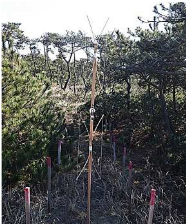
図-1 風速計と飛来塩分の調査装置
