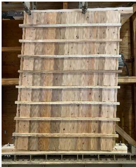
図-16 試験体 3 の S 字に曲がった根太
