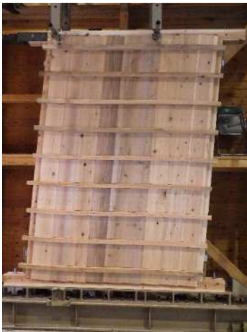
図-22 1/15 red 加力時 (試験体 6)
