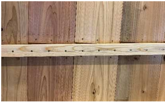
図-21 板のめり込み (試験体 6)
