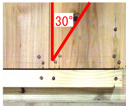
図-8 30°の釘配置（試験体 5）
