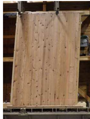
図-24 1/15 red 加力時 (試験体 7)
