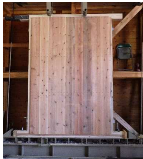
図-10 面内せん断試験の試験状況 (試験体 1)
