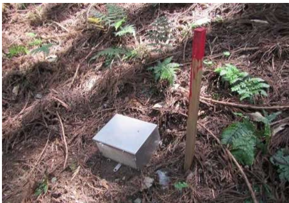
写真-1 土砂受け箱の設置状況
