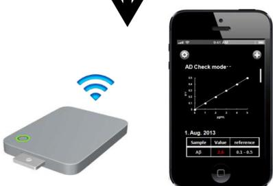
抗原抗体反応による電位の変化を直接検出、
