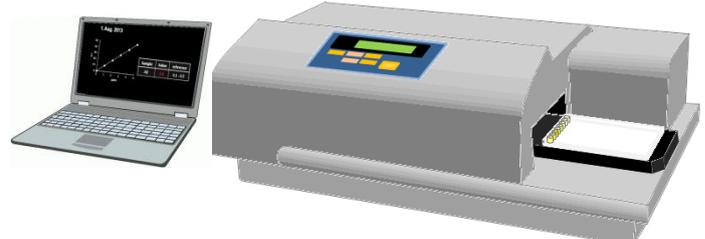
マイクロプレートリーダーで吸光度を測定し検量線から濃度を算出する
