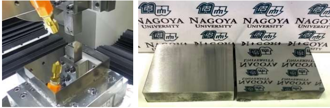
鏡面切削加工 焼入れ材 窒化処理+鏡面切削
