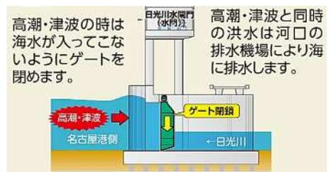
施設の改築により耐震化され津波浸水を防御
