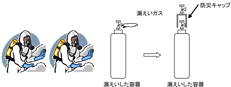
空気呼吸器装着とアンモニアガスの漏えいした容器の処置の訓練
