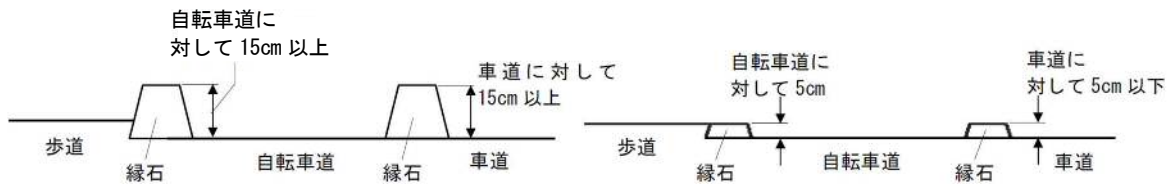
図 12.1 自転車道の分離構造の例
