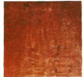
2種ケレン 主として動力工具を用いて、さびや旧塗膜を除去した程度。 (白い部分は鉄の金属光沢、かっ色部分は) 素地鉄、赤色部分は塗膜の残さい)
