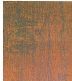
3種ケレン 手工具を主として劣化塗膜やさびを除去した程度。2種に近い状態。 (黒色部分は素地鉄、赤色部分は下塗り残) 存塗膜、赤色部分は上塗り残存塗膜)
