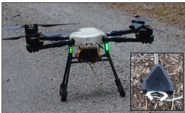
写真－1 使用したドローンと荷掛けフック
