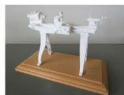
米式旋盤 3Dプリンタによる作成された立体形状
