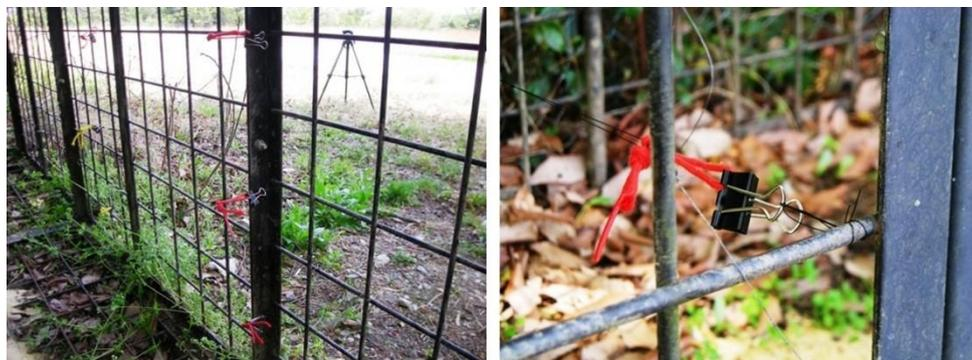
図1 実験用トリガーの設置方法
