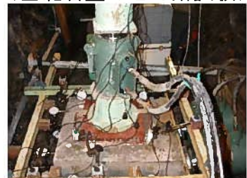
＜基礎岩盤のせん断試験＞
