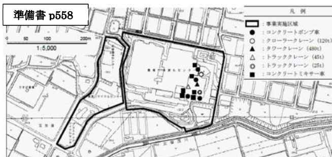
6 図 8-2-9(1) 建設機械の稼働状況及び稼働位置 (工事開始後 30 ヶ月目 (建設工事))
