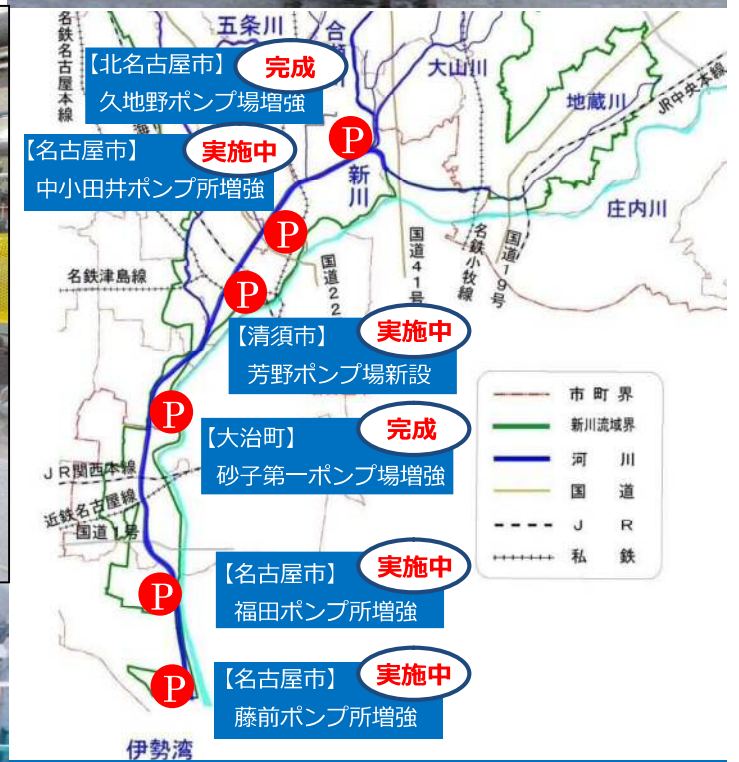
清須市は、芳野ポンプ場を新設しています。平成28年に供用開始する予定で、地域排水の改善期待できます。（排水量：6.22m 3 /s）
