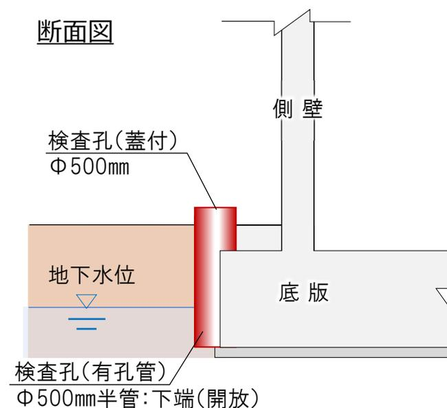
検査孔：コンクリート壁面の定期点検用
